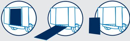
**DESMONTABILIDAD Y TRANSPORTE:** La rampa se retira fácilmente del vehículo por medio de las manillas situadas a los lados. Una vez retirada la rampa, la superficie de carga queda completamente libre. El sistema de enganche y desenganche rápido permite trasladar la rampa rápidamente de un vehículo a otro.
