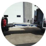
Grâce à un goujon spécial qui verrouille les charnières de la rampe, celle-ci peut être utilisée en pont pour relier deux surfaces de hauteurs différentes (véhicules et marches, quais, etc ...)
