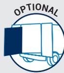
**APERTURA E CHIUSURA:** Su richiesta è disponibile un kit di rotazione esterna che permette di aprire la rampa in senso verticale, come una seconda porta. Questo sistema dà la possibilità di accedere al vano del veicolo, senza utilizzare la pedana (es. carico di pallet a mezzo carrelli elevatori sul furgone).
