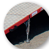
Piedini autoposizionanti regolabili
