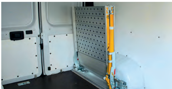
Piano in alluminio anodizzato e forato
