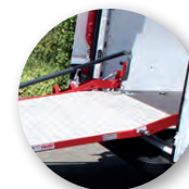
Bandella mobile che raccorda al piano
