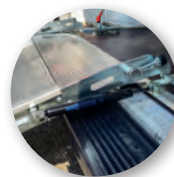
Resorte de gas para facilitar la manipulación
