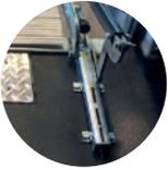
Auf Wunsch kann eine feste Ankerplatte an der Rampe montiert werden. Die somit fest im Fahrzeug verbaute Rampe kann nicht mehr abgenommen werden. Diese Lösung erleichtert und beschleunigt den Einbau auf ca. 30 Minuten.
