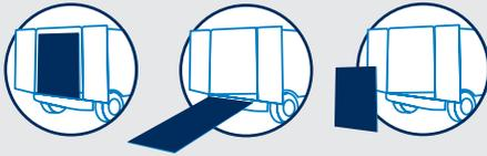
**ABNEHMBARKEIT UND TRANSPORT:** Die Rampe kann anhand der seitlichen Griffe mühelos vom Fahrzeug abgenommen werden. Dadurch steht die ganze Ladefläche wieder zur Verfügung. Das Schnellbefestigungssystem ermöglicht den raschen Aus- und Einbau für Verwendung in mehreren Fahrzeugen.
